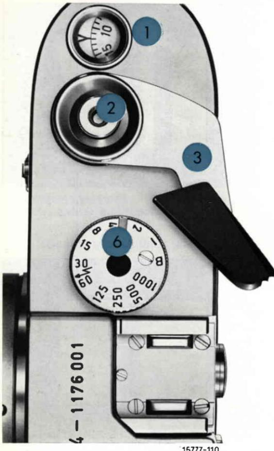
**La palanca de accionamiento rápido (3)** hace avanzar la película – cada vez que se la desplaza a tope – en la proporción de una fotografía, arma el obturador y origina automáticamente el salto del cuentafotografías a la cifra siguiente. La película puede hacerse avanzar, asimismo, por medio de varios movimientos cortos de la citada palanca de accionamiento rápido.
